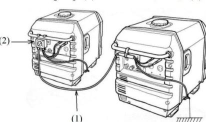
Cáp và Ổ cắm dùng để kết nối song song hai máy phát là phụ kiện đặc biệt, không kèm theo máy. Tuyệt đối không được sử dụng cáp và Ổ cắm khác chung loại.
